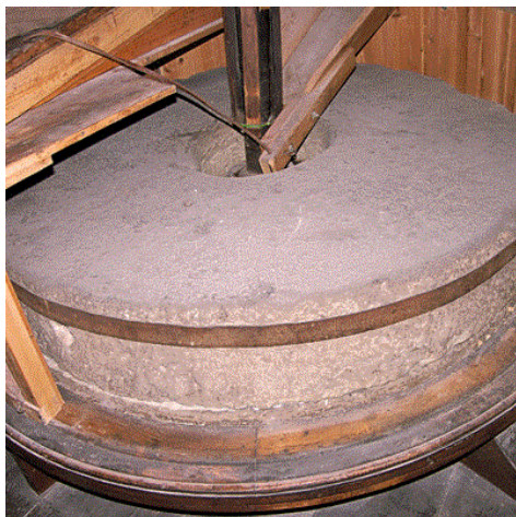
Maal- of molensteenkoppel met boven de loper en onder de ligger.
